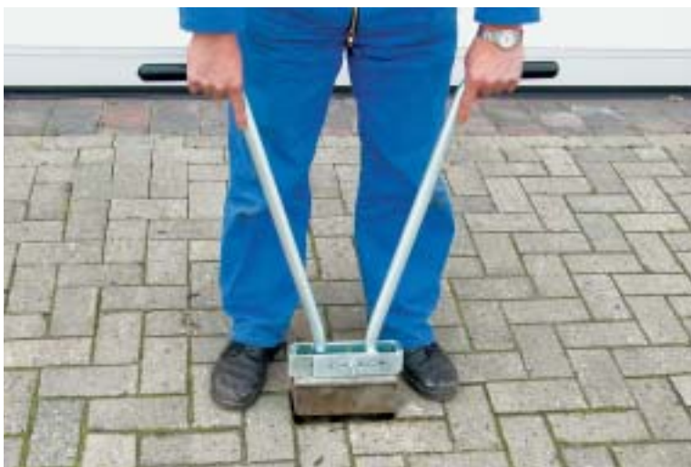
Specialverktyg för att lyfta enskilda stenar ur en beläggning.
