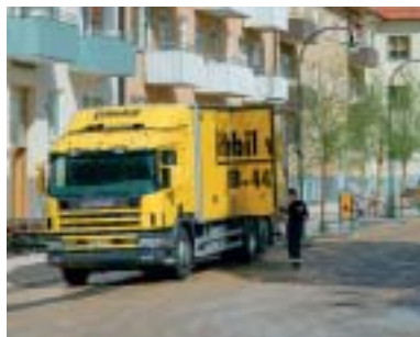
Fordonstyp 3: Tyngre service- och varutransportfordon (axellast max 10 ton).
