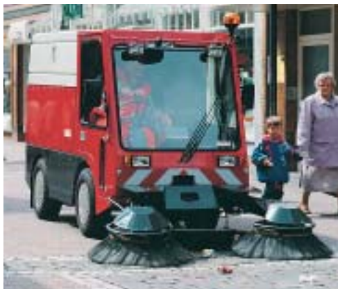
Djupborstade sopmaskiner kan skada fogarna, särskilt på nya beläggningar.
